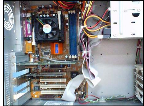
**Step 2** PC 본체 내부의 PCI 슬롯(slot) 중에서 본 게이트웨이 카드를 장착할 임의의 슬롯을 선택합니다.
